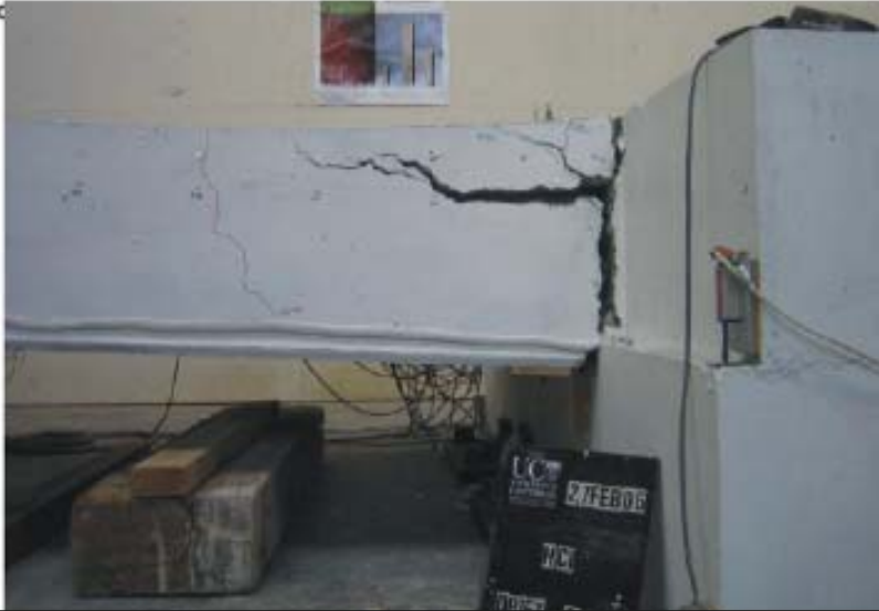
Bruchverhalten einer originalen Hohlkammerdecke nach seismischer Beanspruchung
